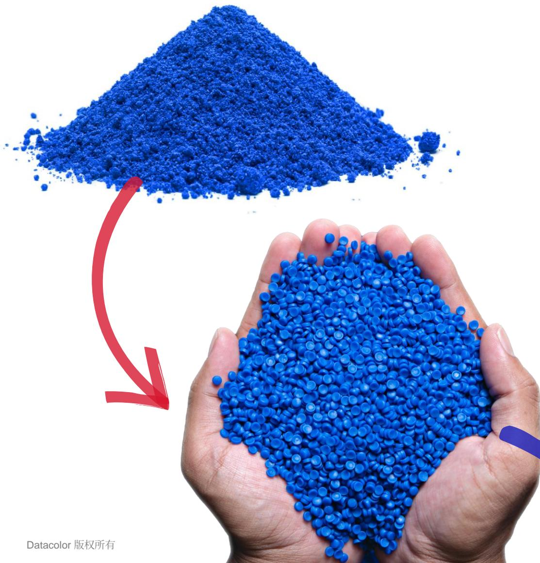
生产彩色塑料产品的第一步通常是由色母或混料机生产颗粒。母料配制机将树脂和着色剂通过各种工艺混合，生产出单色颗粒。
