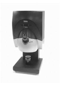
作为一款深受造纸业信任的分光光度计,Datacolor ELREPHO 可用于基准实验室,或用于生产纸浆、纸张和化学品,来管理其彩、亮度、不透明性、漫反射系数、黄度及白度。这款仪器采用漫射/0°光 学几何结构及符合 ISO 2469 标准的自动化、可调节的UV 镜。
