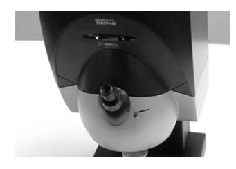
Datacolor ELREPHO使用串行或USB连接与Datacolor TOOLS质量控制软件接口。它支持ISO, DIN, SCAN和TAPPI标准定义的造纸工业测量程序。
